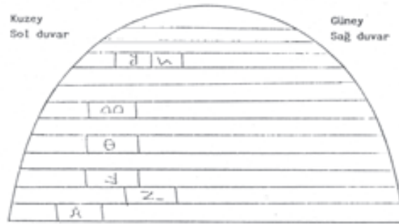
Medrese bölümünün Doğu Eyvanındaki taşçı işaretleri
